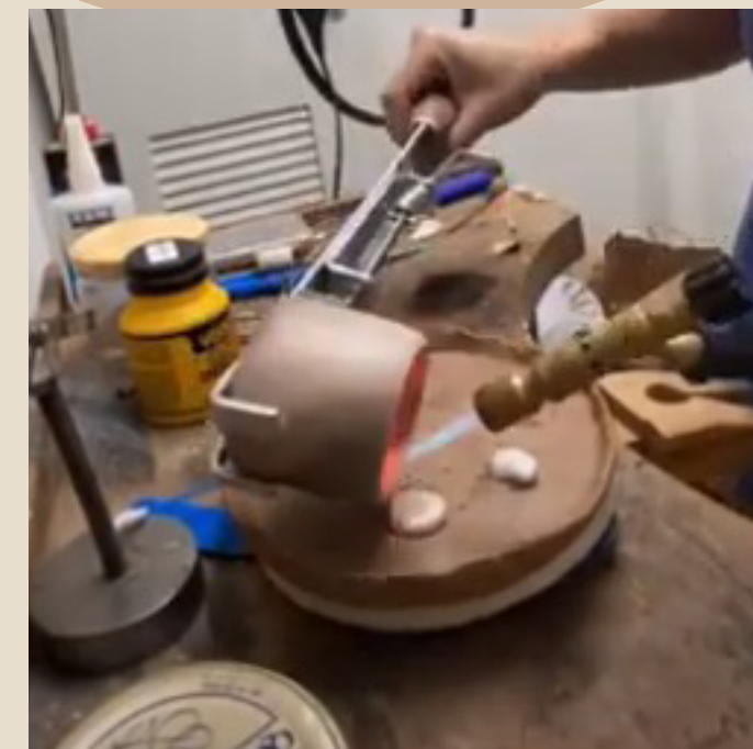
Prata fundida sendo vertida sobre molde em argila
